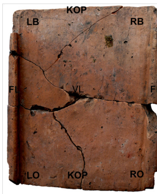
Afb. 8.3 Onderdelen van een tegula. LB = hoek boven links, RB) = hoek boven rechts, LO = hoek onder links, RO = hoek onder rechts, VL = vlak, FL = flens, KOP = boven- of onderzijde. Foto: auteur.
