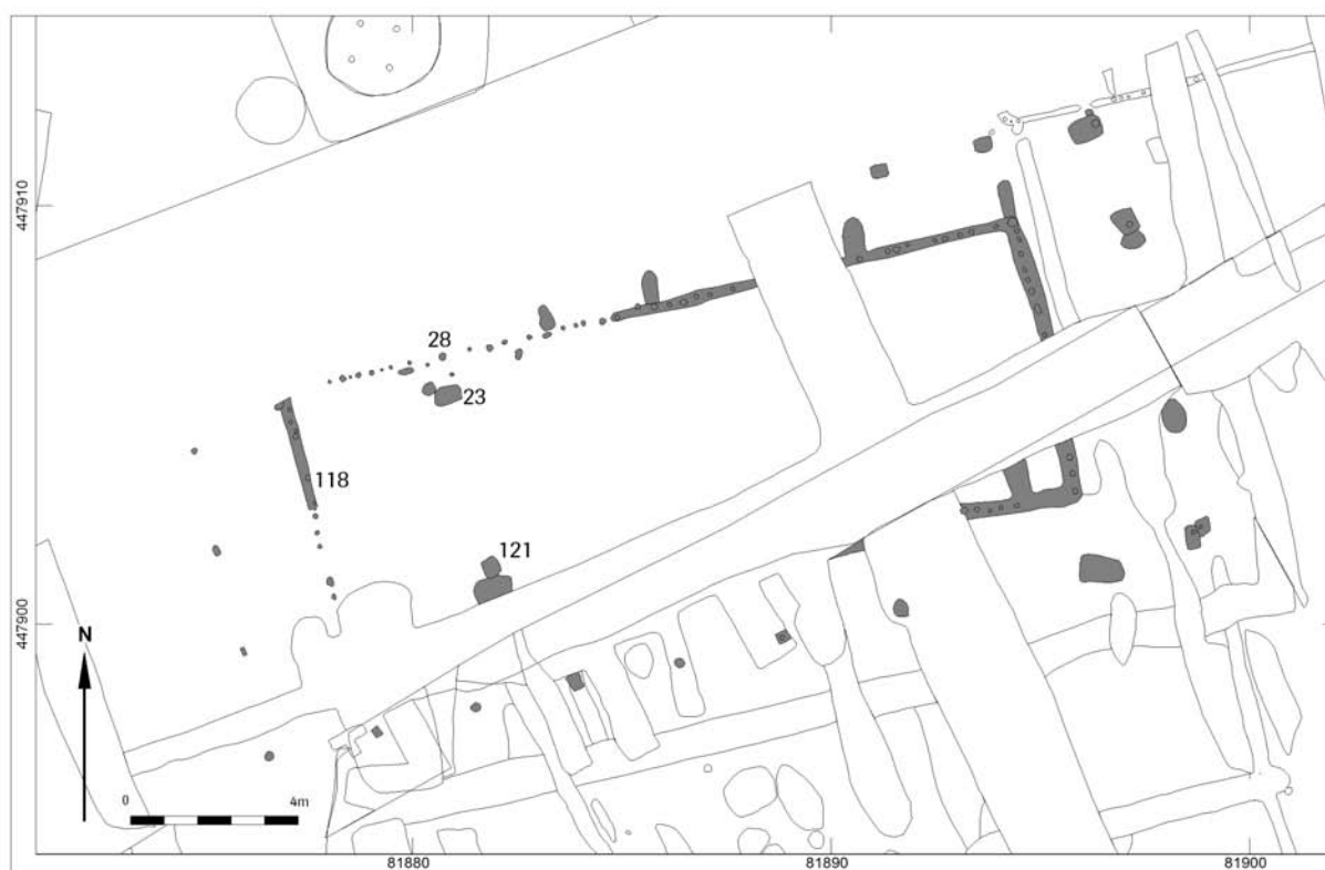
Afb. 4.13 Voorbeeld van een gebouw met porticus, AHR07-Gebouw 1.
